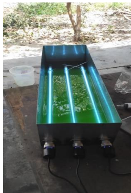
Foto N°3: Desinfección de muestra de 20L con luz UV-C.
